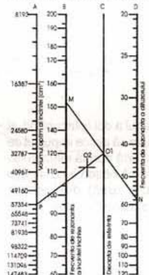
Nomograme pentru determinarea volumului optim al incintelor bassreflex: a). Pentru difuzoare cu diametre >20cm.
